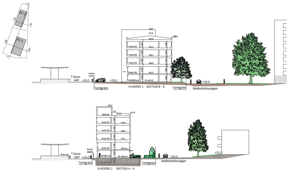
Sektion A-A och B-B som visar förhållandet mellan Kvadern 1 och 2, tunnelbanespåret och Maltesholmsvägen. (Rombus Arkitekter).
